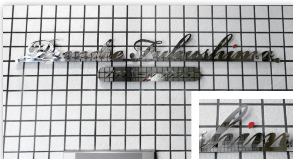
ステンレス切り文字銘板 サイズ：H≒165×W900×t5mm／加工：鏡面仕上げ 一部焼付け塗装 赤
