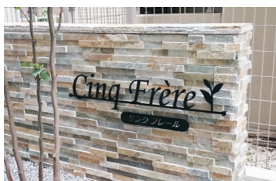
写真 No. 1486-04 品番：KSYT ステンレス切り文字 納期：約 18 日 焼付塗装黒仕上げ サイズ：L=800 t5mm 加工：ボルト出し 10mm 浮かし
