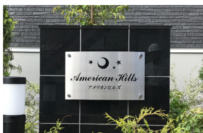
写真 No. 1486-10 品番：R15 アールサイン 納期：約 18 日 サイズ：H300×W500×t2mm 加工：文字エッチング凹黒
