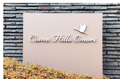
写真 No. 1485-06 品番：KSHL ステンレス切り文字 納期：約 18 日 ヘアライン仕上げ サイズ：L=800 t5mm 加工：ボルト出し 10mm 浮かし
