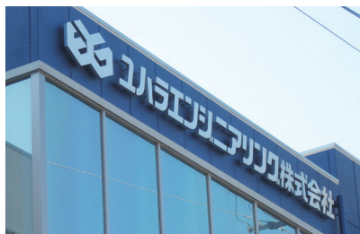
写真 No. 1482-01 品番：特注 ステンレス箱文字 納期：約18日 サイズ：1文字 約500mm角 加工：SUS箱文字・LEDバックライト
