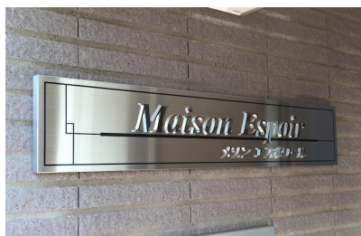
写真 No. 1482-04 品番：特注 ステンレス銘板 納期：約18日 サイズ：H160×W800×D20mm 加工：切り文字付き、一部エッチング
