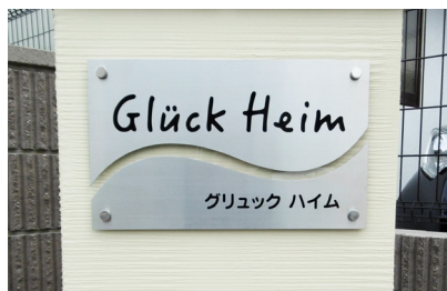
写真 No. 1477-07 品番：特注 ステンレス銘板 納期：約18日 サイズ：H300×W500×t7mm 加工：文字エッチング凹黒
