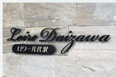
写真 No. 1420-03 品番：KSYT 切り文字銘板 ステンレス切り文字 焼付塗装黒 サイズ：L=600 t5mm 仕 様：ボルト出し 10mm 浮かし
