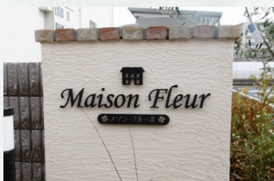
写真 No. 1420-05 品番：KSYT 切り文字銘板 ステンレス切り文字 焼付塗装黒 サイズ：L=630 t5mm 仕 様：ボルト出し 10mm 浮かし
