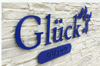
写真 No. 1420-04 品番：KSYT 切り文字銘板 ステンレス切り文字 焼付塗装青 サイズ：L=900 t5mm 仕 様：ボルト出し 10mm 浮かし
