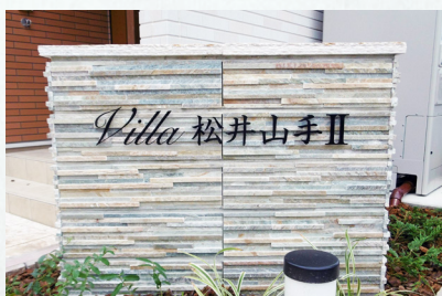
写真 No. 1420-02 品番：KSYT 切り文字銘板 ステンレス切り文字 焼付塗装黒 サイズ：L=750 t5mm 仕 様：ボルト出し 10mm 浮かし
