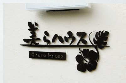
写真 No. 1420-06 品番：KSYT 切り文字銘板 ステンレス切り文字 焼付塗装黒 サイズ：L=600 t5mm 仕 様：ボルト出し 10mm 浮かし
