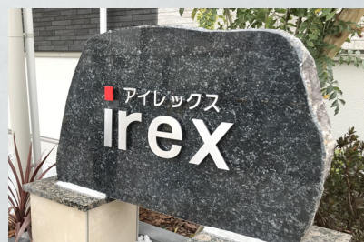
写真 No. 1420-12 品番：KSYT 切り文字銘板 ステンレス切り文字 一部焼付塗装 サイズ：L=400 t5mm 仕 様：ボルト出し 10mm 浮かし
