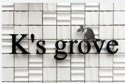
写真 No. 1420-07 品番：KSYT 切り文字銘板 ステンレス切り文字 焼付塗装黒 サイズ：L=370 t5mm 仕 様：ボルト出し 10mm 浮かし
