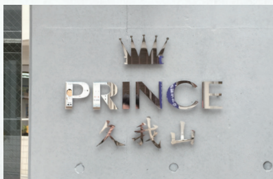
写真 No. 1418-02 ステンレス切り文字 鏡面仕上げ 品番：KSMR サイズ：L=500mm t5mm 切り文字銘板 仕 様：ボルト出し 10mm 浮かし
