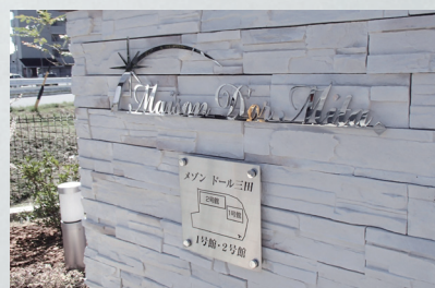
写真 No. 1418-12 ステンレス切り文字 鏡面仕上げ 品番：KSMR サイズ：L=800 t5mm 切り文字銘板 仕 様：ボルト出し 10mm 浮かし
