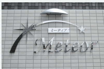
写真 No. 1418-07 ステンレス切り文字 鏡面仕上げ 品番：KSMR サイズ：L=1200 t5mm 切り文字銘板 仕 様：ボルト出し 10mm 浮かし
