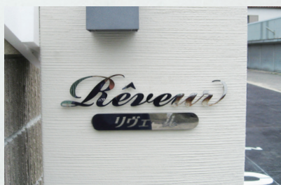
写真 No. 1418-10 ステンレス切り文字 鏡面仕上げ 品番：KSMR サイズ：L=400 t5mm 切り文字銘板 仕 様：ボルト出し 10mm 浮かし
