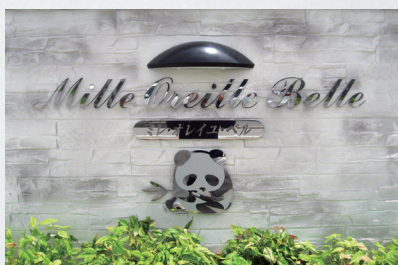
写真 No. 1418-08 ステンレス切り文字 鏡面仕上げ 品番：KSMR サイズ：L=1200mm t5mm 切り文字銘板 仕 様：ボルト出し 10mm 浮かし
