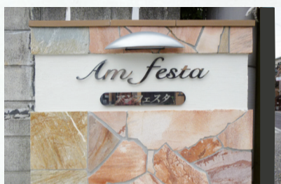
写真 No. 1418-04 ステンレス切り文字 鏡面仕上げ 品番：KSMR サイズ：L=700 t5mm 切り文字銘板 仕 様：ボルト出し 10mm 浮かし
