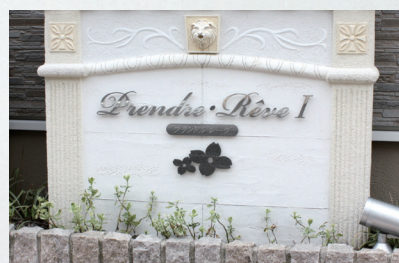
写真 No. 1418-06 ステンレス切り文字 鏡面仕上げ 品番：KSMR サイズ：L=800 t5mm 切り文字銘板 仕 様：ボルト出し 10mm 浮かし
