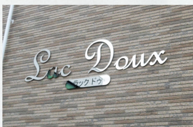
写真 No. 1418-05 ステンレス切り文字 鏡面仕上げ 品番：KSMR サイズ：L=2000 t5mm 切り文字銘板 仕 様：ボルト出し 10mm 浮かし
