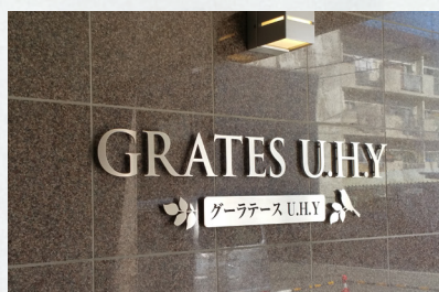
写真 No. 1416-05 品番: KSHL 切り文字銘板 ステンレス切り文字 ヘアライン仕上げ サイズ: L=1200 t 5mm 仕 様: ボルト出し 10mm 浮かし
