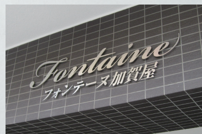
写真 No. 1416-12 品番: KSHL 切り文字銘板 ステンレス切り文字 ヘアライン仕上げ サイズ: L=1000 t 5mm 仕 様: ボルト出し 10mm 浮かし
