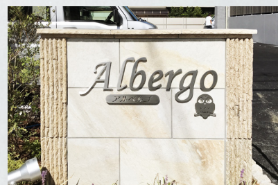
写真 No. 1416-09 品番: KSHL 切り文字銘板 ステンレス切り文字 ヘアライン仕上げ サイズ: L=800 t 5mm 仕 様: ボルト出し 10mm 浮かし
