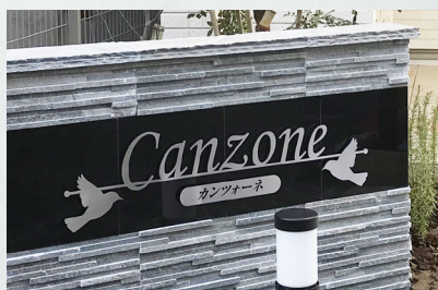
写真 No. 1416-10 品番: KSHL 切り文字銘板 ステンレス切り文字 ヘアライン仕上げ サイズ: L=800 t 5mm 仕 様: ボルト出し 10mm 浮かし
