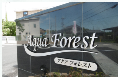
写真 No. 1416-01 品番: KSHL 切り文字銘板 ステンレス切り文字 ヘアライン仕上げ サイズ: L=800 t 5mm 仕 様: ボルト出し 10mm 浮かし
