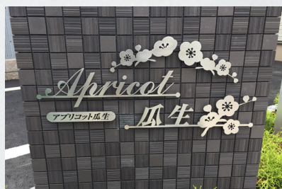
写真 No. 1416-08 品番: KSHL 切り文字銘板 ステンレス切り文字 ヘアライン仕上げ サイズ: L=800 t 5mm 仕 様: ボルト出し 10mm 浮かし
