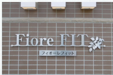
写真 No. 1416-02 品番: KSHL 切り文字銘板 ステンレス切り文字 ヘアライン仕上げ サイズ: L=1000 t 5mm 仕 様: ボルト出し 10mm 浮かし
