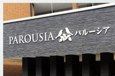
写真 No. 1416-06 品番: KSHL 切り文字銘板 ステンレス切り文字 ヘアライン仕上げ サイズ: L=2500 t 5mm 仕 様: ボルト出し 10mm 浮かし
