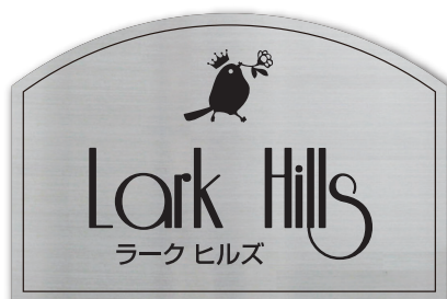
写真 No. 1412-07 仕様：カマボコ型（裏蓋式） 品番：S12 ステンレス銘板 サイズ：H400×W600×D20mm 加工：文字エッチング凹黒
