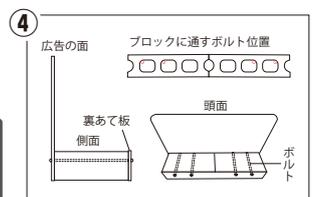
④ ブロックの穴を利用してボルトを通します。
