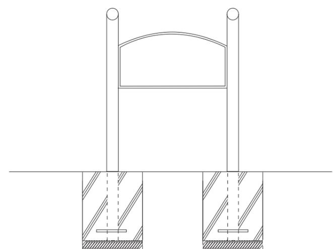
※柱を埋め込む前に銘板をセットしますと、水平、垂直が出しにくくなります。
